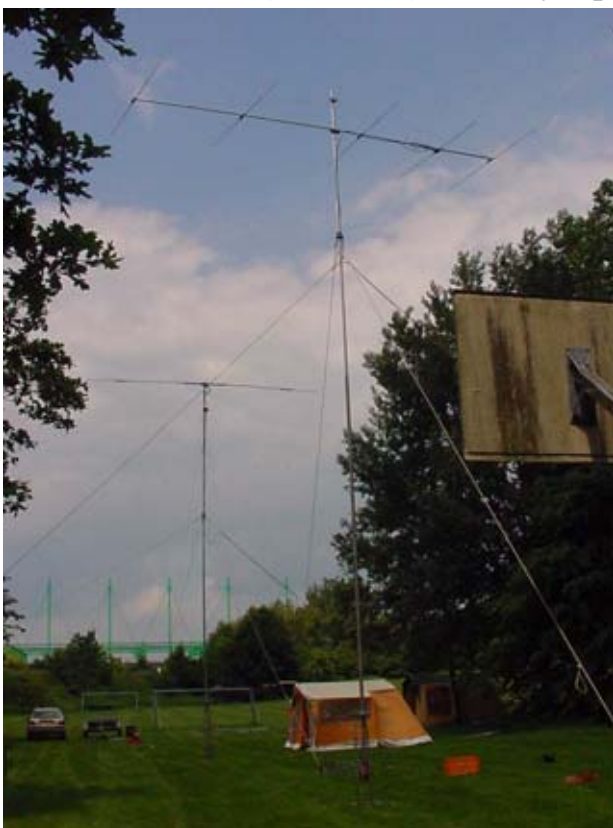
Boven: Opbouw 3 elements HF-beam, Onder : 6m beam (PA3EXV) en rotary dipole.
